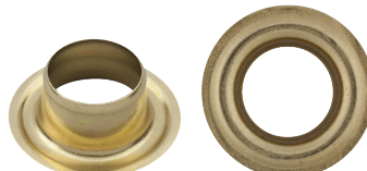
OEIL BACH J15 D: 21 d: 12,1 HT: 8,2 Existe avec bord rond BR15 Available with round edge BR15
